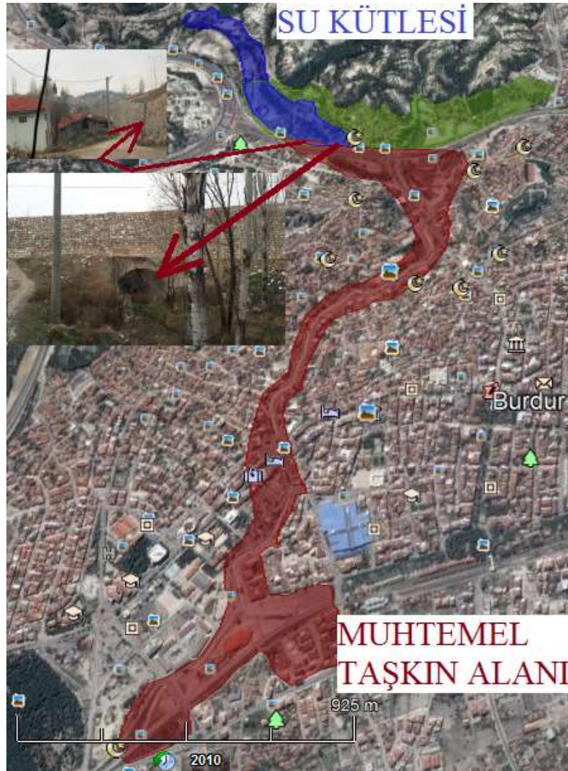
Şekil 2.30 Suni Barajın Altında Kalan Evler, Menfez ve Baraj Yıkıldığında Muhtemel Taşkın Alanı (KURTMAN, T., 2018)
